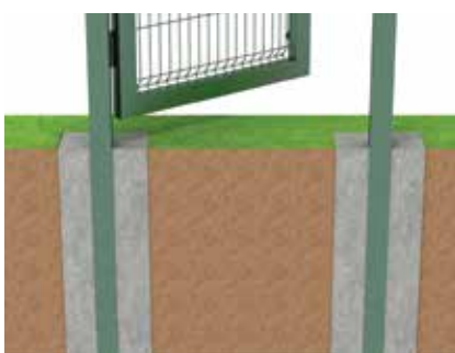
Монтаж с бетонированием несущих столбов
