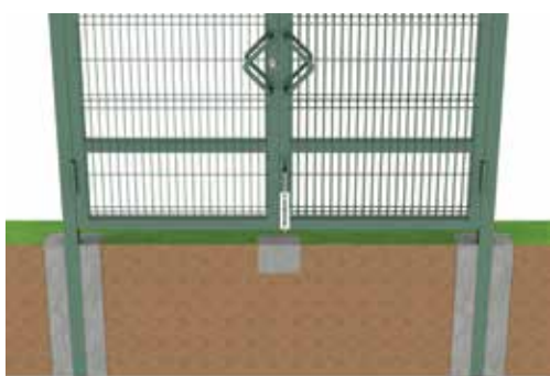
Монтаж с бетонированием столбов
