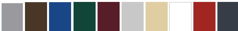
RAL 7004 серый стандарт RAL 8014 коричневый RAL 5005 синий RAL 6005 зеленый RAL 3005 бордо RAL 9006 серебро RAL 1014 бежевый RAL 9003 белый RAL 3000 красный RAL 7016 антрацит
