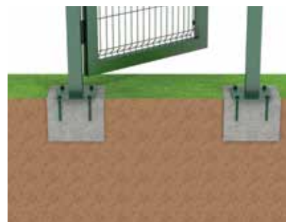
Монтаж на фланцы
