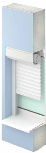
□ Накладной монтаж, короб наружу
