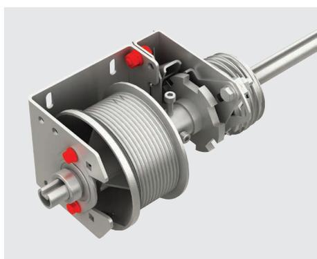
**Система быстрого монтажа Qiusk Fix.** В П-образных кронштейнах и устройствах безопасности уже закреплены болты. Для монтажа достаточно поставить вал в ложе кронштейнов и закрепить гайки. Система Qiusk Fix позволяет осуществлять монтаж одной рукой.
