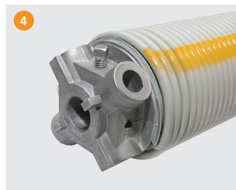
Пружины проходят дробеструйную обработку и окрашиваются антифрикционным порошковым покрытием для защиты от коррозии. Специальное покрытие уменьшает силу трения витков пружины. Дробеструйная обработка увеличивает срок службы пружины.
