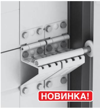
■ **Усиленные боковые опоры** устанавливаются на ворота серии ISD01, перекрывающие большие проемы, для увеличения прочности и надежности конструкции. Центральный паз обеспечивает наиболее точное позиционирование держателя ролика.
